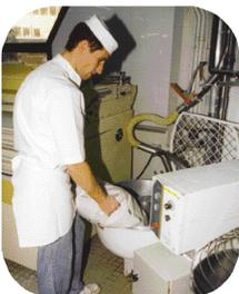
3. Basculer le sac sur la cuve avec l'ouverture vers le bas
