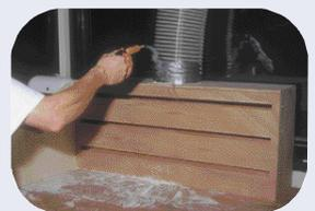
De la même manière qu'avec le pétrin, il a été réalisé un essai avec le fumigène pour montrer l'efficacité de l'extraction.
