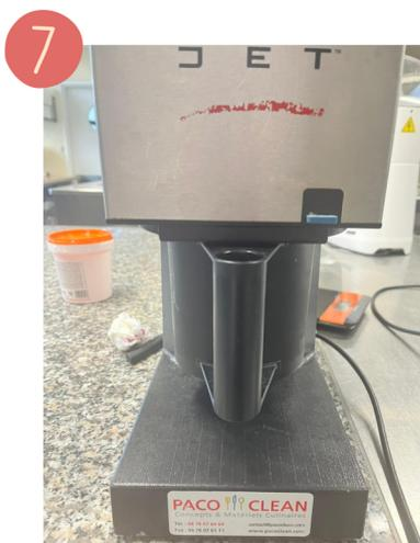
7 Positionner le porte-gobelet sur l'appareil, caler en tournant d'un quart de tour.
