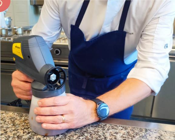
Emplir le réservoir du pistolet à peinture et l'enclencher sur la pompe en partie supérieure. Pour une pulvérisation velours, le mélange doit être chaud (40/45 °C).
