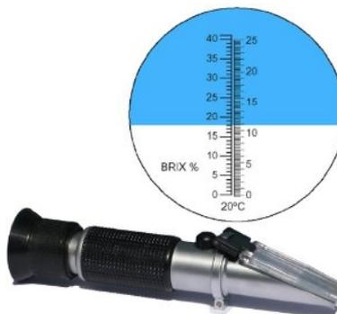
Le degré Brix est l'unité de mesure du réfractomètre. Il indique en pourcentage la teneur en extrait sec d'un produit. Cet outil utilisé par les professionnels permettant de déterminer le pourcentage de saccharose dans une solution aqueuse est extrêmement fiable.
